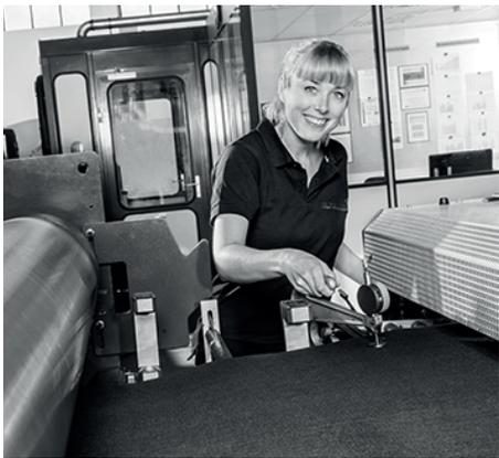
Dickenmessung von Graphitfilz für die thermische Isolation von Schmelztiegeln
