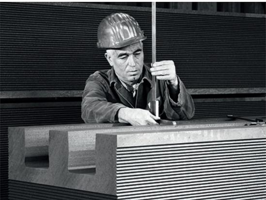
Toleranzprüfung an Graphitkathoden zur Herstellung von Aluminium
